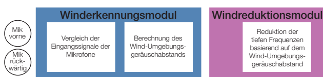
Abbildung 3. Vereinfachtes Schema des Dual-Mikrofon-Eingangs und WindGuard
